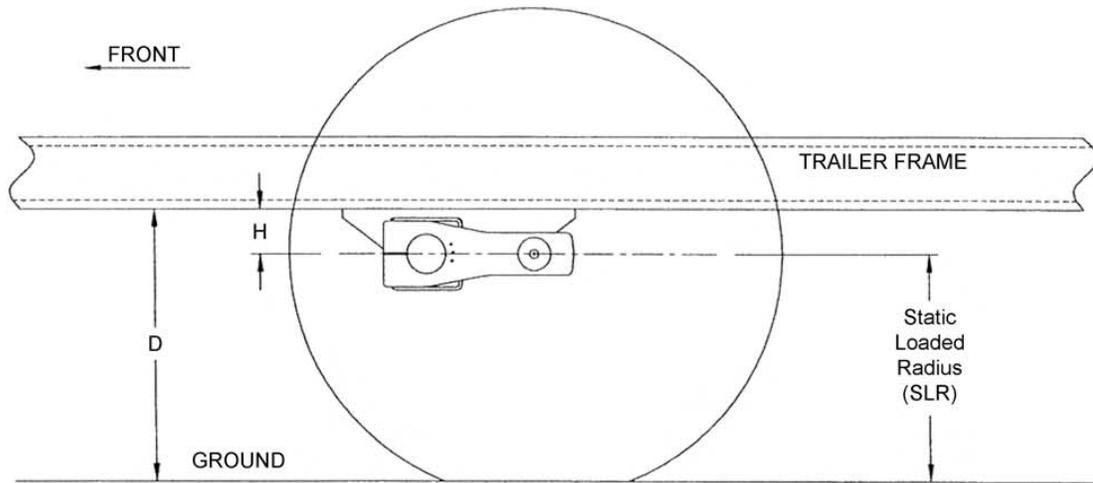
THE OPTIMUM ARM ANGLE AT LOAD IS HORIZONTAL. THE TRAILER FRAME SHOULD BE LEVEL.
